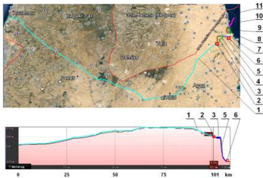
Рис. 1. План-схема гидроаккумулирующего комплекса и трассы трубопровода от Средиземного моря : 1 – трасса трубопровода, 2 - бесплотинная ГЭС, 3 – верхнее водохранилище, 4 – дамба верхнего водохранилища, 5 - турбинный водовод, 6 – ГАЭС, 7 – открытый канал, 8 – нижнее водохранилище, 9 – дамба нижнего водохранилища, 10 - водовод в море, 11 - северный бассейн Мертвого моря.
